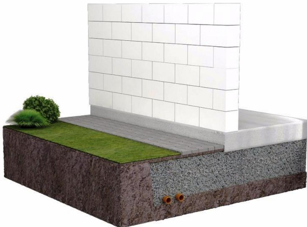
CON LA GHIAIA DI VETRO CELLULARE DECORUS E' POSSIBILE REALIZZARE L'ISOLAMENTO TERMICO ALLA BASE DELL'INVOLUCRO EDILIZIO, SENZA SOLUZIONI DI CONTINUITÀ
