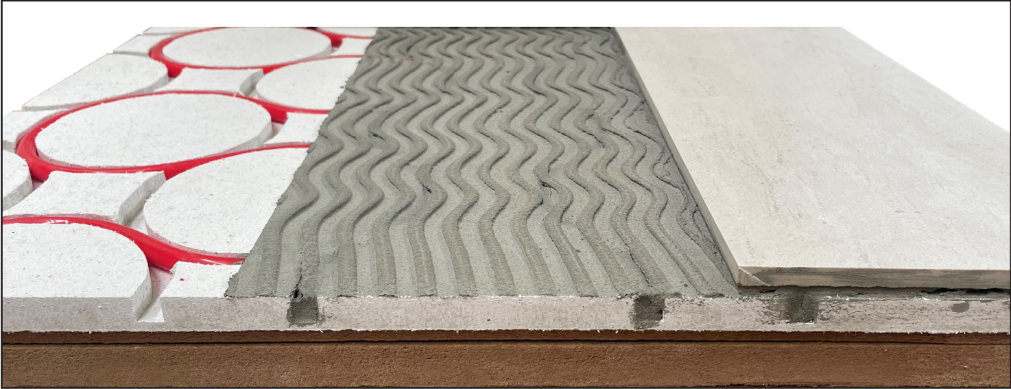
Dettaglio sistema FinoTherm® FINO con pannello in gessofibra preaccoppiato a strato isolante in fibra di legno, secondo strato isolante in fibra di legno da 10 mm e finitura piastrella in ceramica
