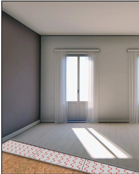
Dettaglio sistema FinoTherm® SLIM con strato di finitura in parquet
